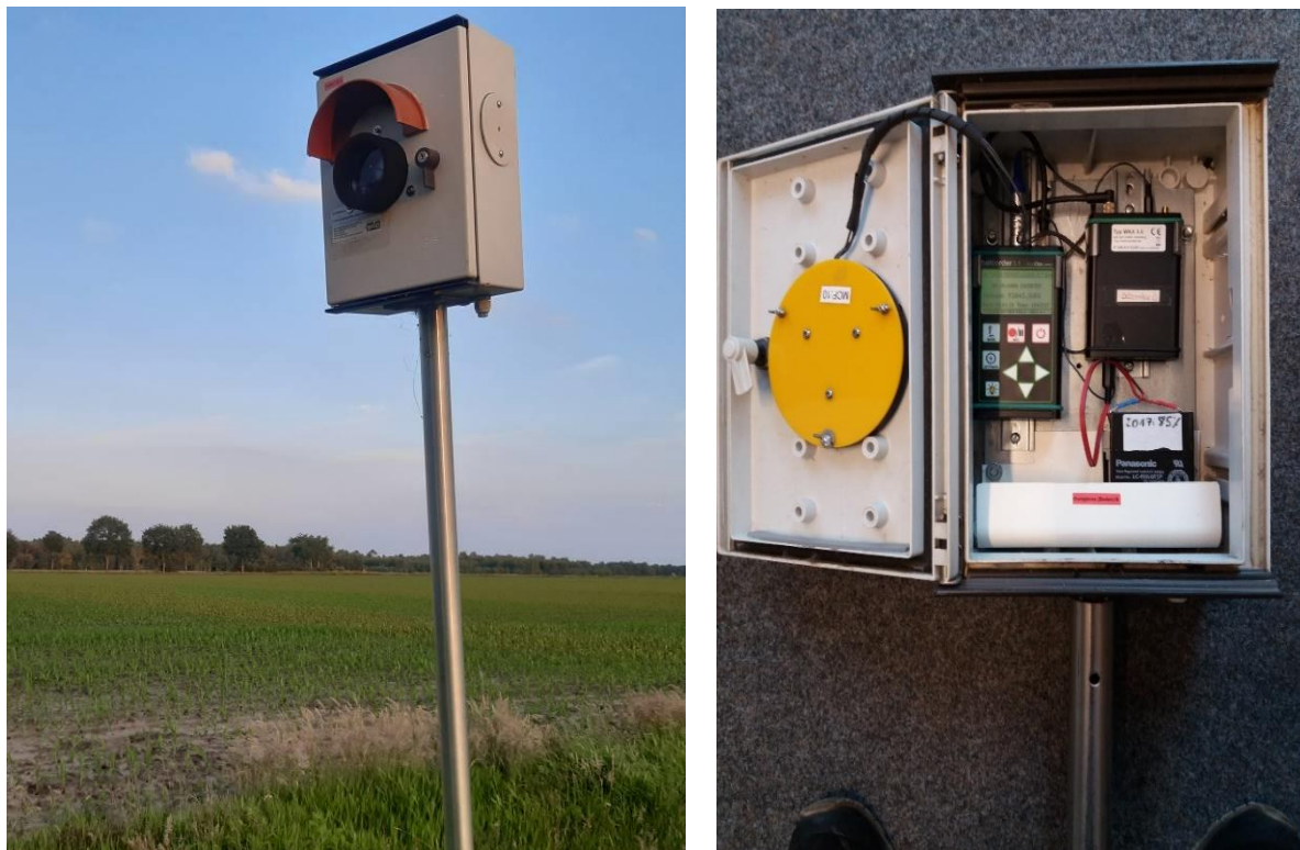
Abbildung 9: Dauererfassungsgerät B im Geländeeinsatz (links) und Innenansicht (rechts)
