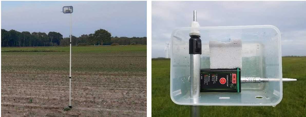
Abbildung 11: Horchbox HK 06 im Einsatz (links) und Innenaufbau einer Horchbox (rechts)
