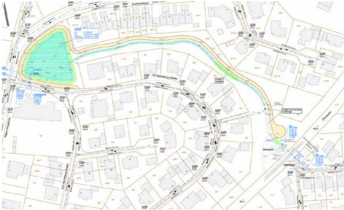
**Bild: Planungen zur Abkopplung der Regenwasserkanalisation in der Monikastraße durch Querung der Bahntrasse mittels Düker und Rückhaltung an der Hagen-Ringstraße**
